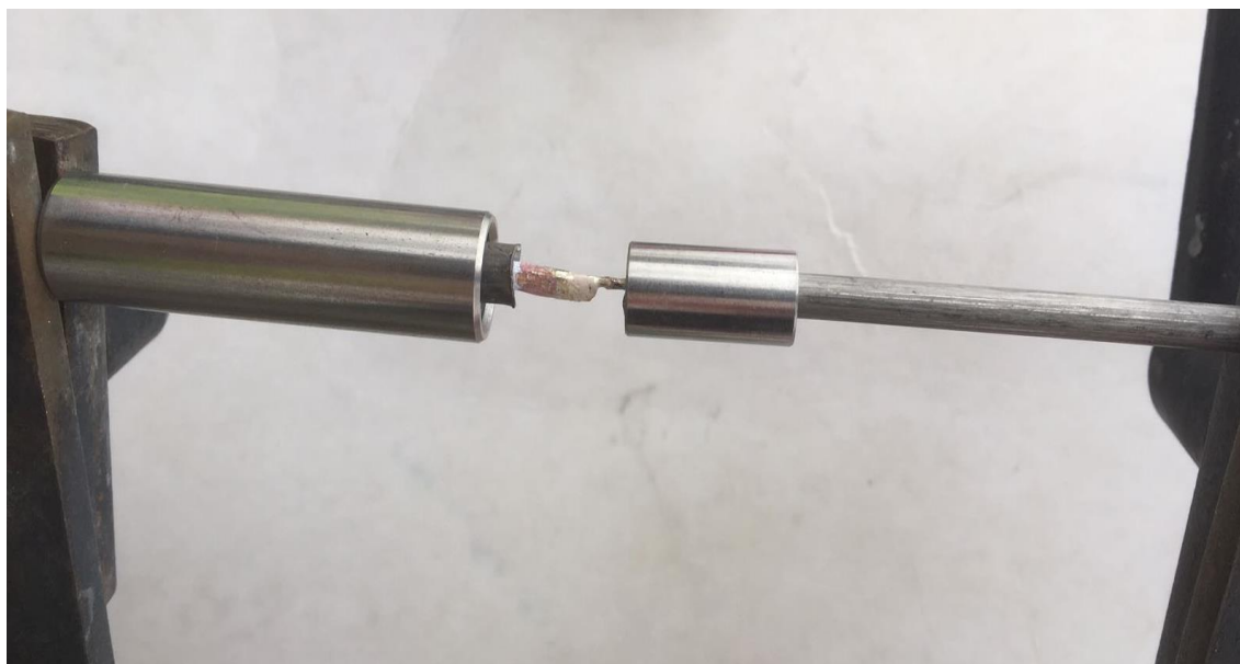
Kuva 17. Kylmä- ja lämpökaapeleiden johtimien juottaminen [13.]
