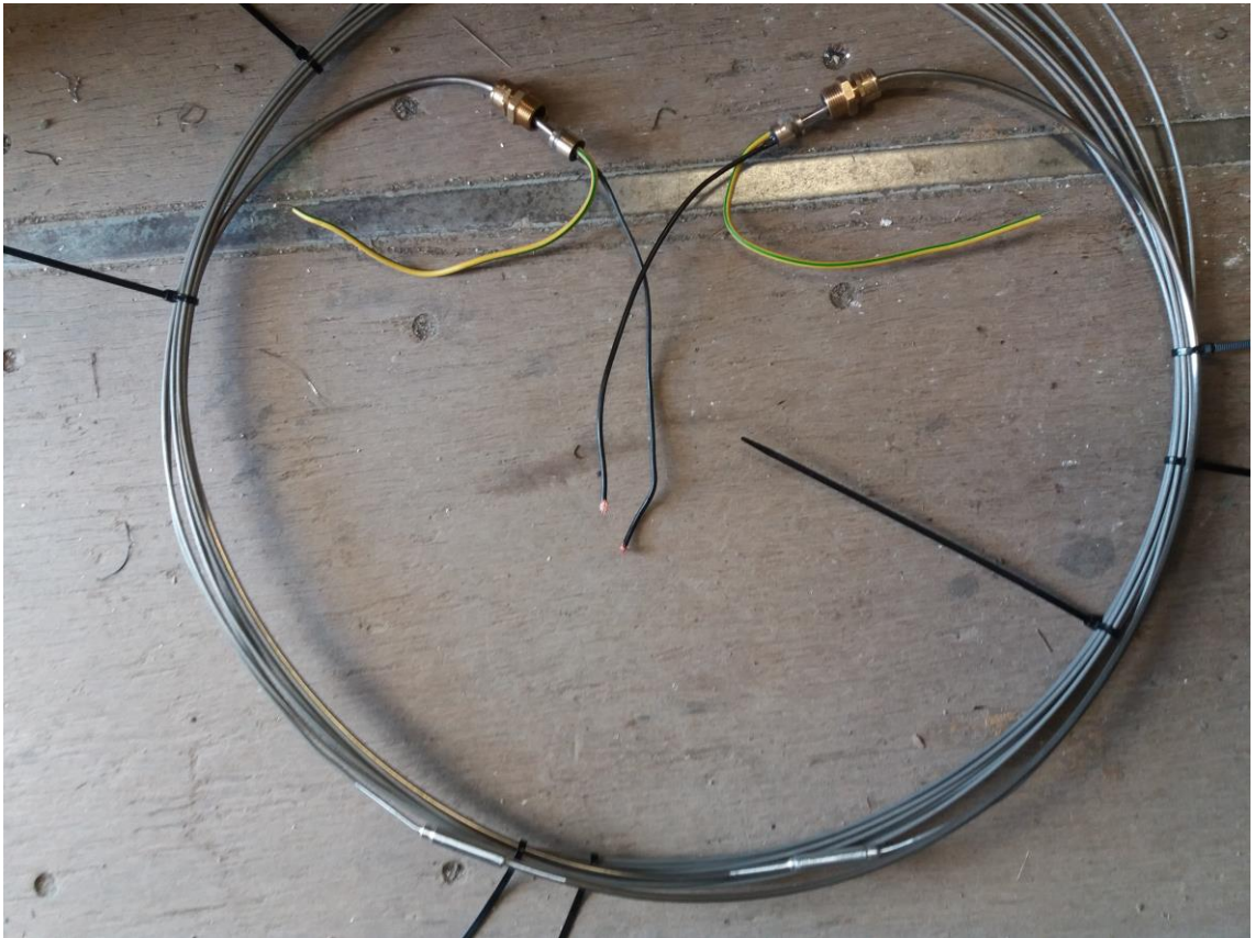
Kuva 20. Valmis metallivaippainen lämmityskaapeli [13.]
