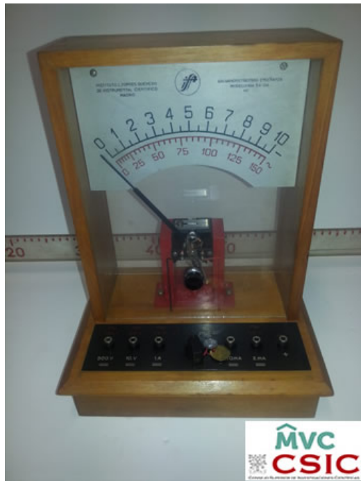
Galvanómetro para enseñanza, 1954 . ITEFI CSIC.
