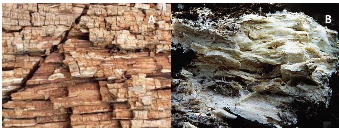
Figura 3. Aspecto de la madera tras la actuación de hongos de podredumbre parda (A) y hongos de podredumbre blanca (B).
