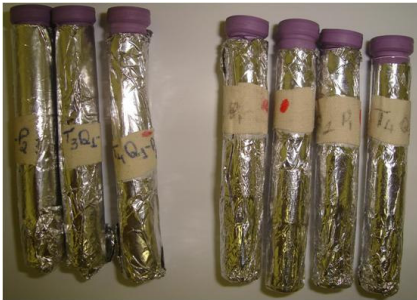
Figura 3. Ésteres metílicos de ácidos graxos acondicionados em vidros revestidos com papel alumínio
