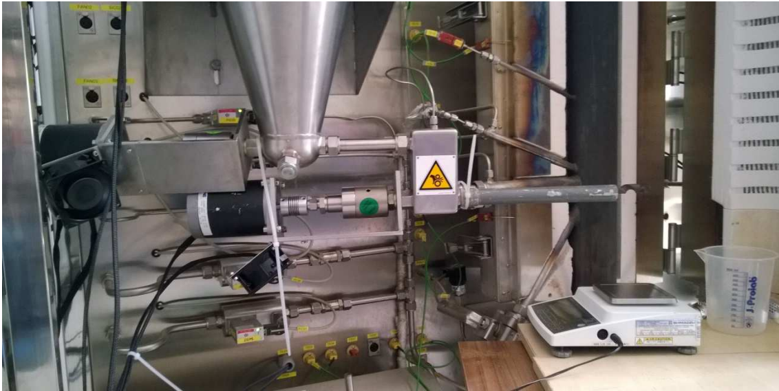
Figura 6.2 - Aparato experimental utilizado na calibração do sistema de alimentação de sólidos.
