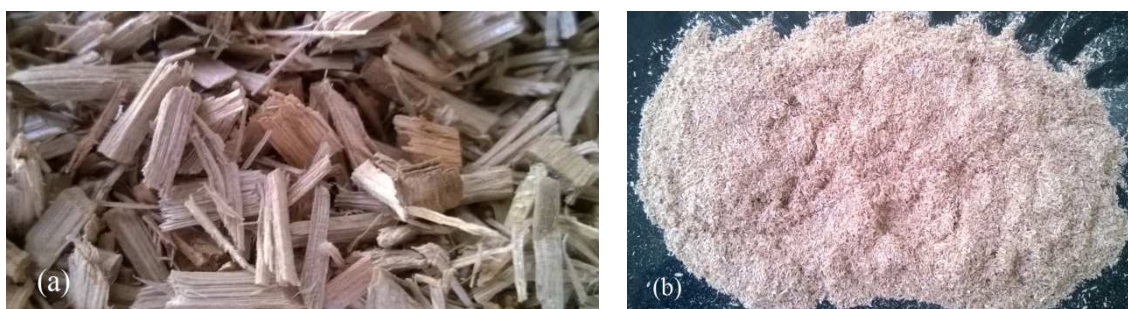
Figura 4.1 – Biomassa moída a) em moinho de martelo b) em moinho de facas willey.
