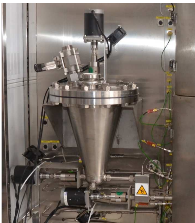
Figura 6.1 - Sistema de alimentação de biomassa da Planta Piloto de Pirólise e Gaseificação.
