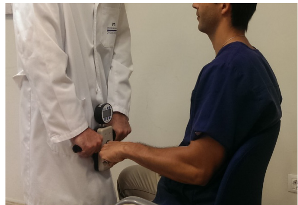
Figura 2. Dinamómetro de torsión Baseline Hydraulic Wrist Dynamometer .
