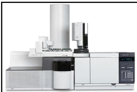
**Figura 2.3.** Plataforma metabolómica GC-MS usada. Equipo para estudios metabolómicos no dirigidos: Sistema cromatográfico GC Agilent 7890 acoplado a un espectrómetro de masas QToF/MS Agilent 7200.
