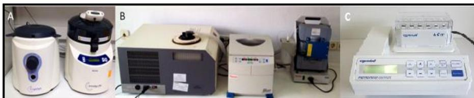
**Figura 2.1.** A) Precellys 24 Dual equipado con un refrigerador Cryolys. B) Savant SpeedVac conectado a una bomba de vacío y a una trampa de vapor refrigerada. C) Thermomixer
