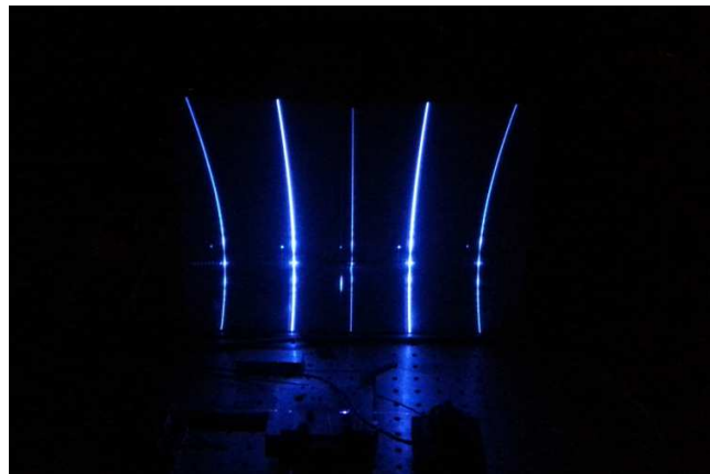
Figura 1.1.3 Patrón de difracción de un haz láser al grabar una red de Bragg mediante la técnica de máscara de fase. Se utiliza un láser de argón a 488 nm con un cristal doblador para obtener radiación UV a 244 nm.
