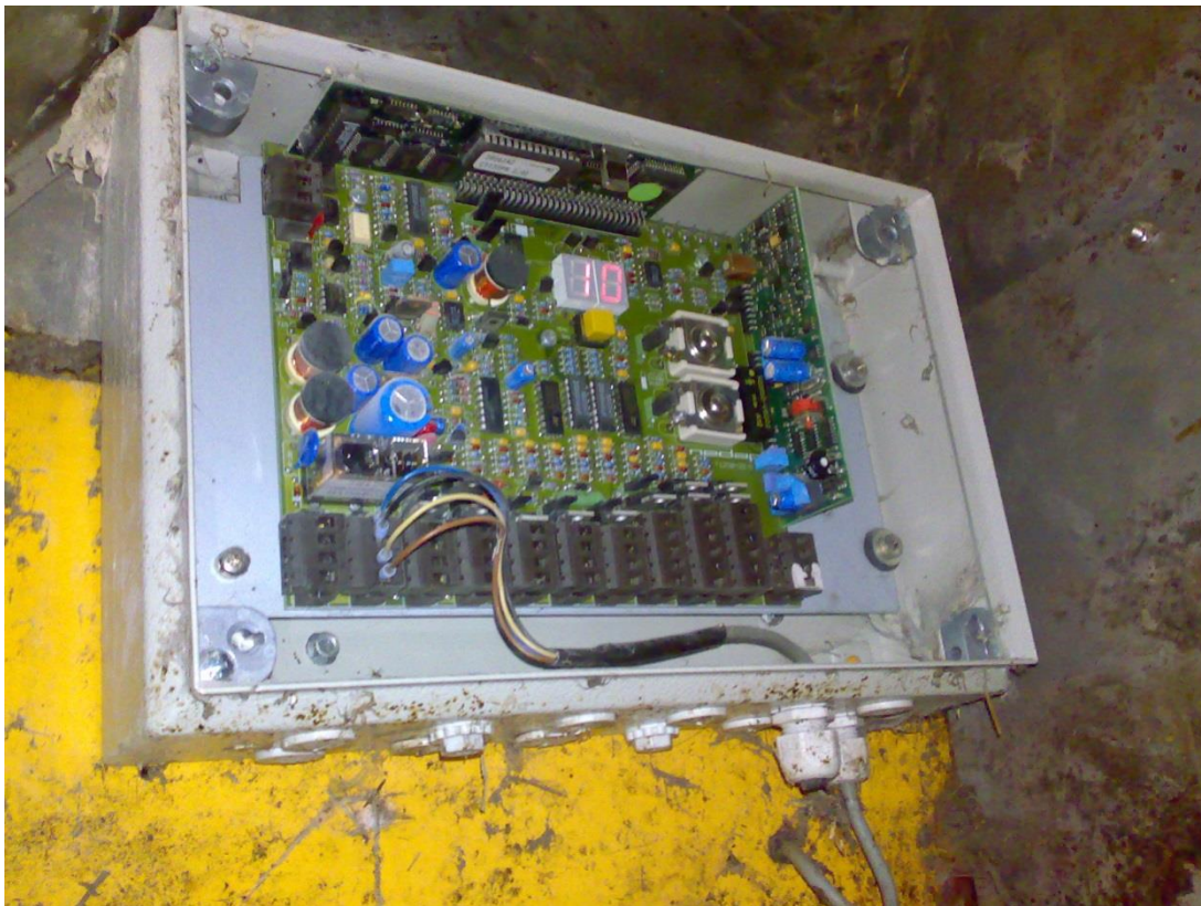
Kuva 6. Kotieläintalouden automaatio on usein sijoitettu haastavaan ympäristöön. Kosteus, pöly ja eläinten kontaktit saattava aiheuttaa laitteiden rikkoontumisia.
