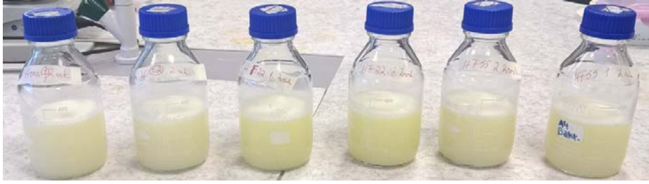
Kuva 2a. Heranäytteet 1–3 (rinnakkaiset) 2 vrk:n fermentoinnin jälkeen. Näyte 2 väriltään kellertävän vihertävä.
