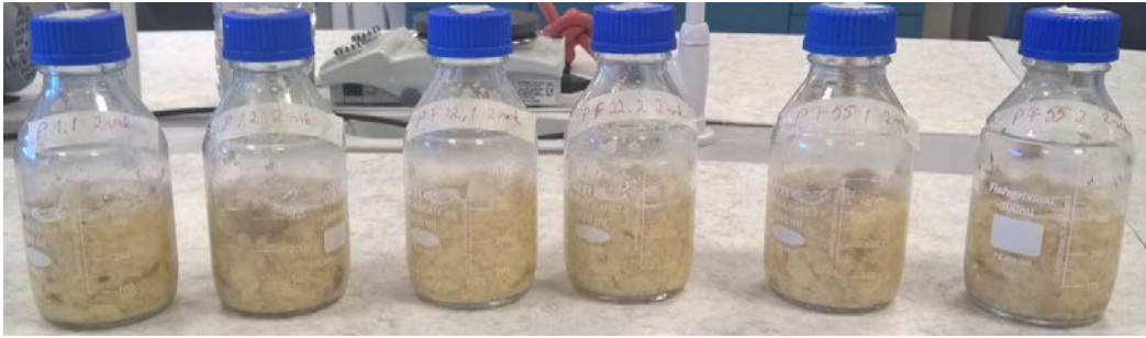
Kuva 3a. Perunankuorimassanäytteet 1–3 (rinnakkaiset) 2 vrk:n fermentoinnin jälkeen. Näyte 2 väriltään hie- man vaaleampi.
