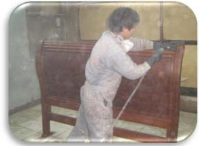
**10. Lacado:** Consiste en el acabado final, en esta etapa se realiza un proceso de protección a los diferentes muebles para que de esta manera queden listo para la venta.
