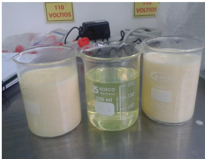
Figura 23. Proceso de microfiltración. Muestra 2 Microfiltración Entrada – Permeado – Concentrado.
