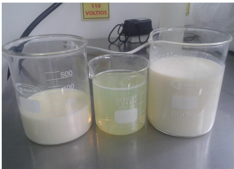
Figura 22. Proceso de microfiltración. Muestra 1 Microfiltración Entrada – Permeado – Concentrado.
