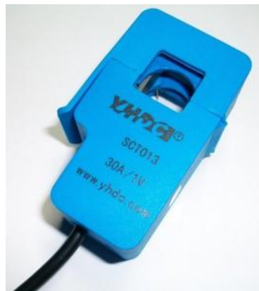
Figura 2.5. Sensor de corriente de efecto hall SCT013 [15].
