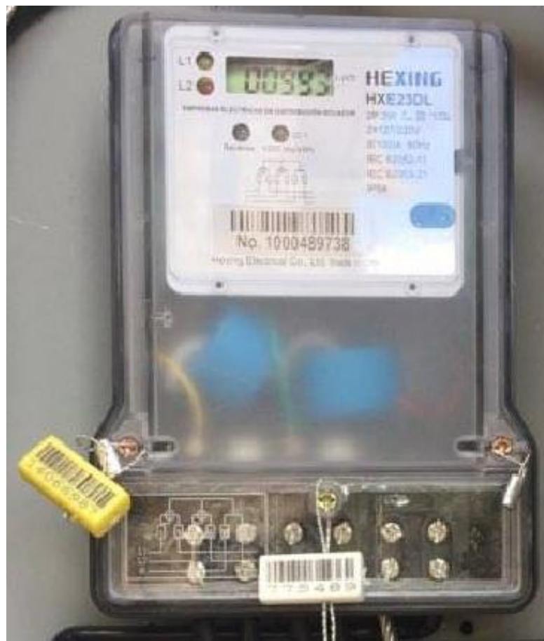
Figura 4.6. Medidor electrónico utilizado por la EERCS.
