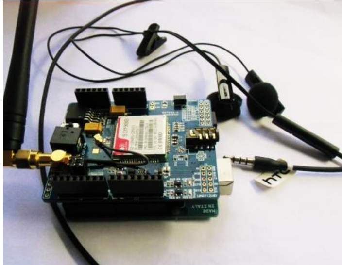
Figura 2.15. Módulo GPRS / GSM V1.0 [27]
