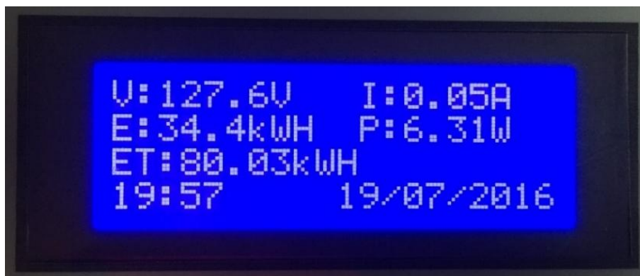
Figura 4.3. LCD indicando voltaje, corriente, potencia, energía acumulada, hora, fecha.
