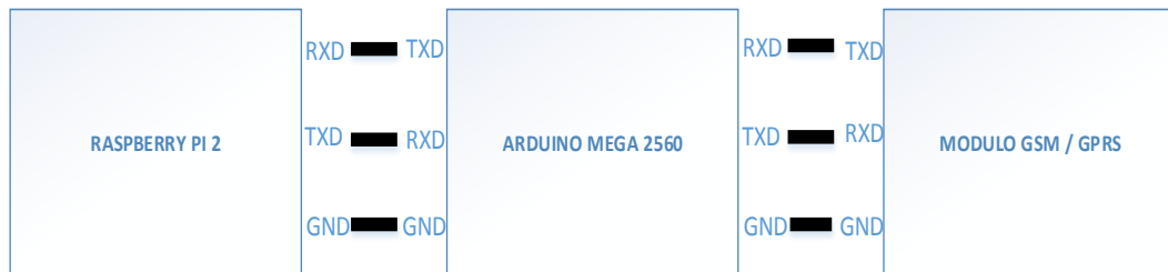
Figura 2.12. Esquema explicativo de la conexión serial entre Raspberry 2, Arduino mega 2560, Módulo GPRS / GSM V1.0.
