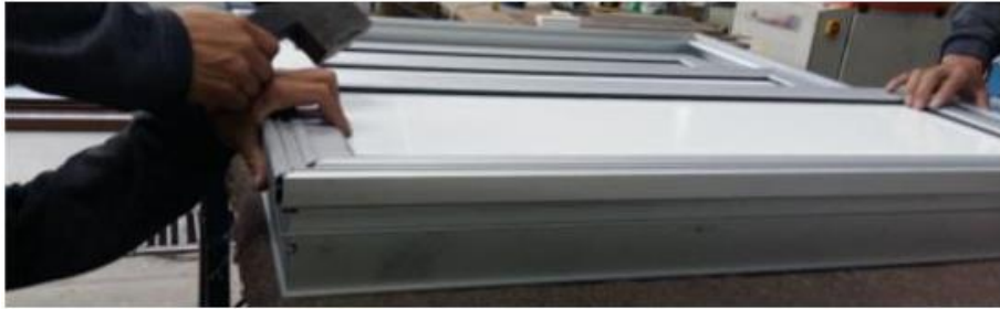
Figura 51. Colocación de acrílico
