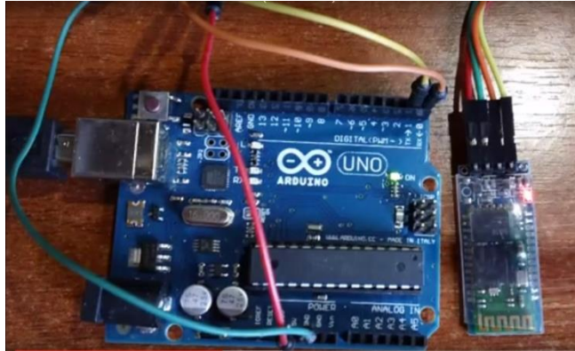
Figura 42. Conexión eléctrica arduino - bluetooth
