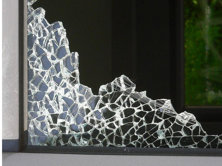
Figura 8. Detalle del vidrio templado material de seguridad, al romperse se granula, pero queda en el mismo lugar
