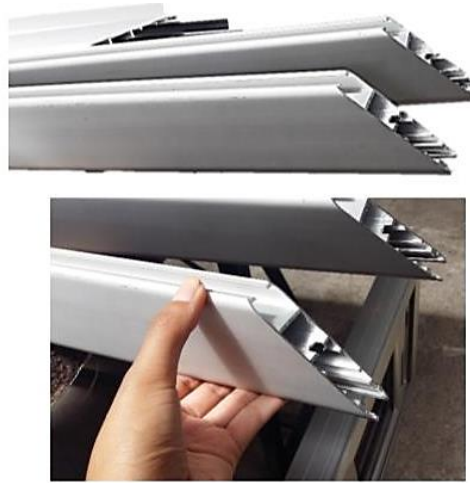
Figura 47. Corte de perfiles móviles o de paneles móviles
