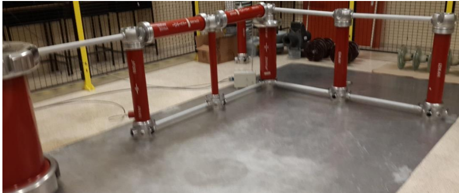
Ilustración 74. Circuito rectificador simple con resistencia de carga ( R=10\text{ M}\Omega )
