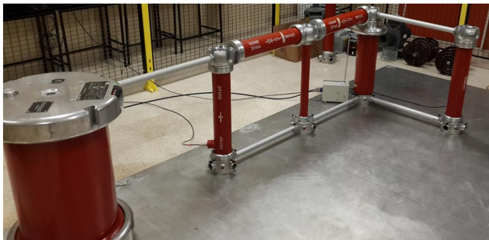
Ilustración 73. Circuito rectificador simple sin resistencia de carga ( R=\infty \Omega )
