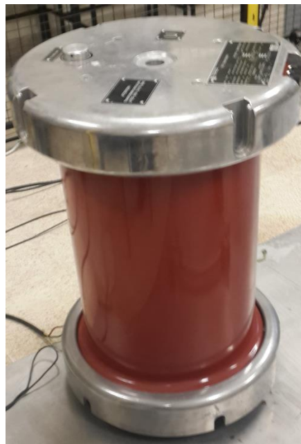
Ilustración 24. Transformador de Prueba
