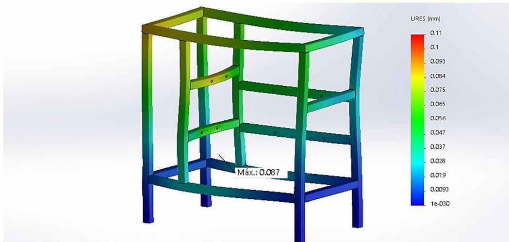
Figura 44. Representación de (URES) del bastidor en Solid Works
