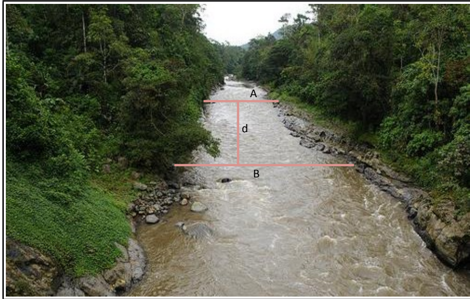
Figura 2.6: Medición de distancia en el Río.
