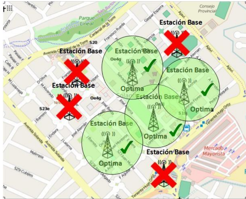
Figura 5. Resultado de la Optimización de Estaciones Base para Cubrir 100 Usuarios (Medidores Inteligentes).
