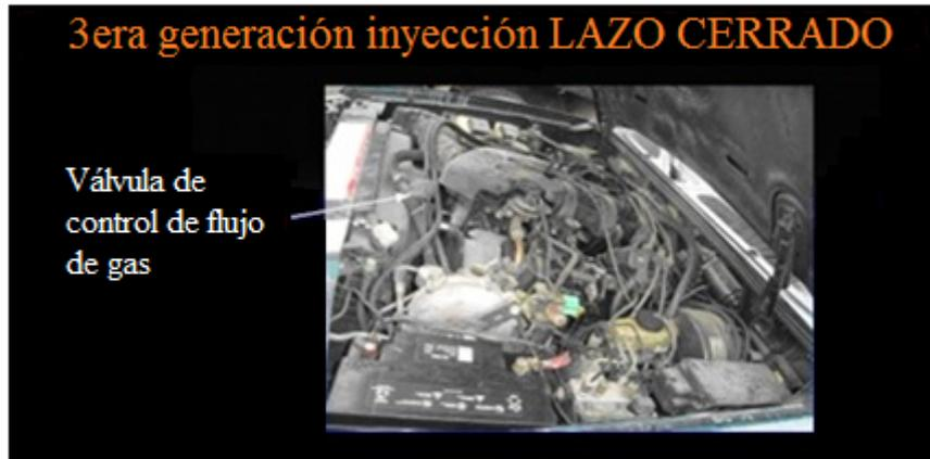
Figura 1.4: Sistema de gas convencional de tercera generación
