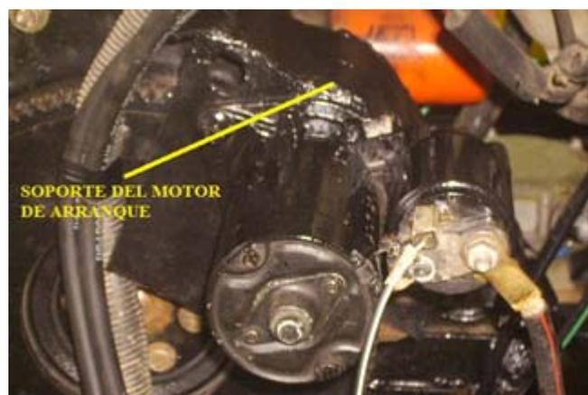
Figura 3.23: Adaptación del Soporte del Motor de Arranque
