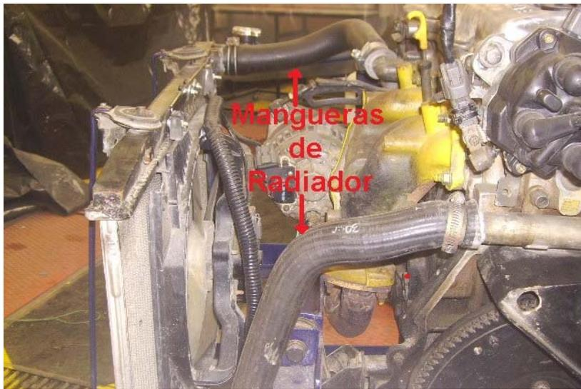
Figura 3.18: Mangueras del Radiador
