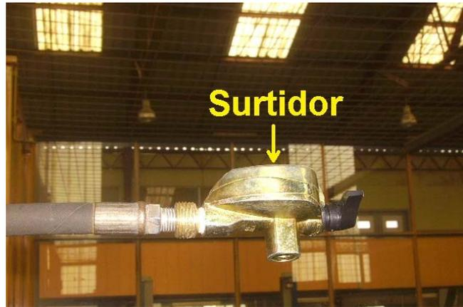
Figura 1.36: Surtidor de llenado del sistema
