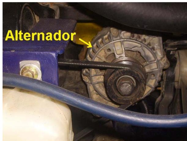
Figura 3.21: Adaptación de una polea en el Alternador
