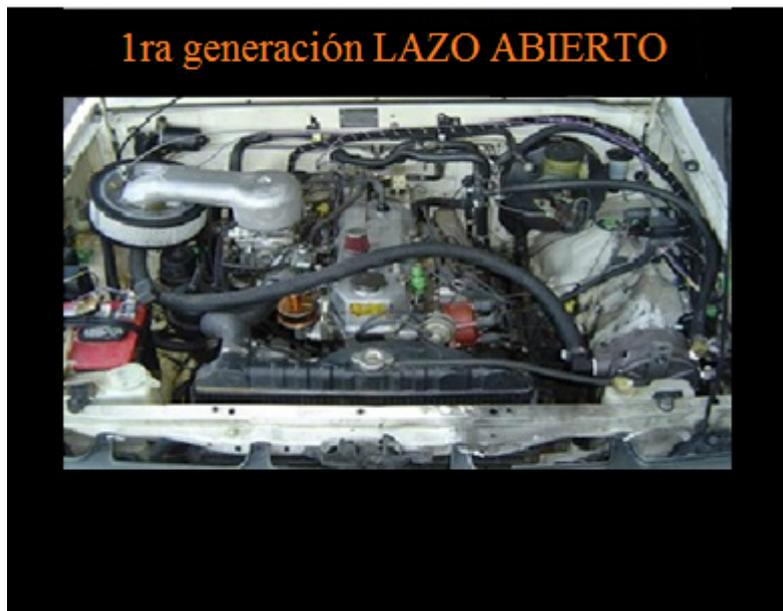
Figura 1.2: Sistemas de gas convencional de primera generación
