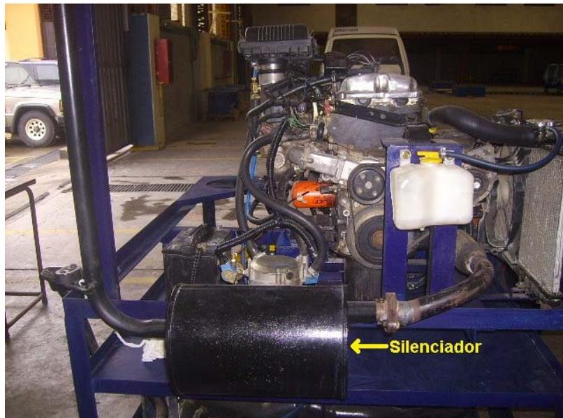
Figura 3.24: Adaptación Del Tubo De Escape
