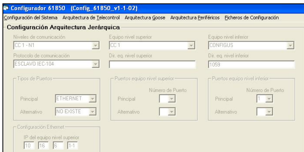
Figura 3.63. Configuración arquitectura jerárquica – Configurator 61850. 139
