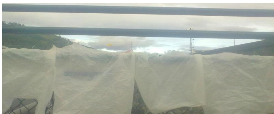
Figura 21. Exposición de bolsas oxo-biodegradables a radiación solar
