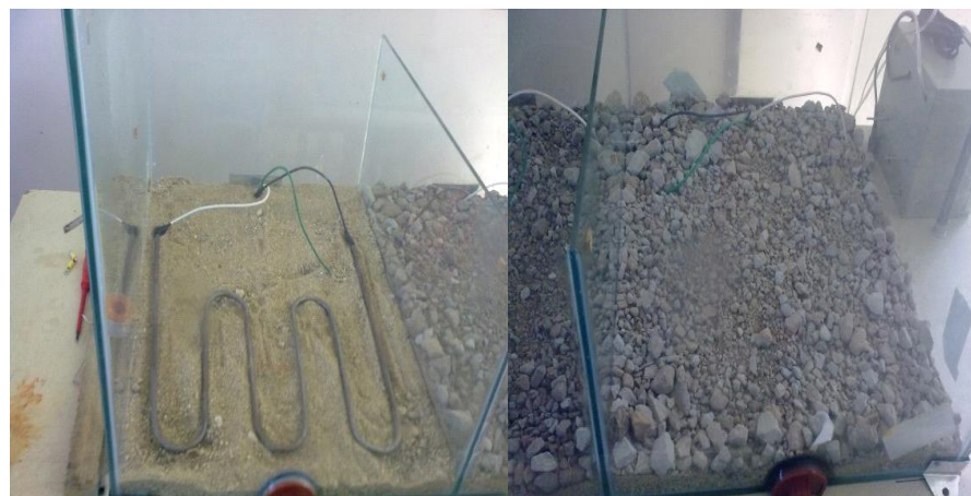
Figura 29. Colocación de gravas en el biorreactor.
