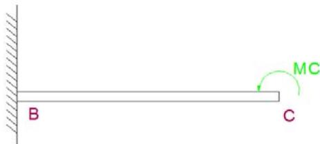
**Figura 3.11** Diagrama de los dos tramos para el cálculo de la deflexión máxima
