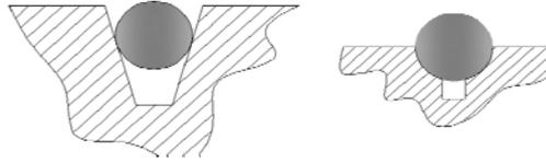
**Figura 1.6** a) Polea de tracción - Perfil trapecoidal, b) Polea de reenvío - Semiesférica sin entalla
