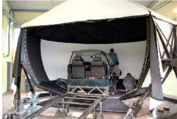
Fig. 23. Plataforma Stewart utilizada en un simulador de manejo, por la firma BMW
