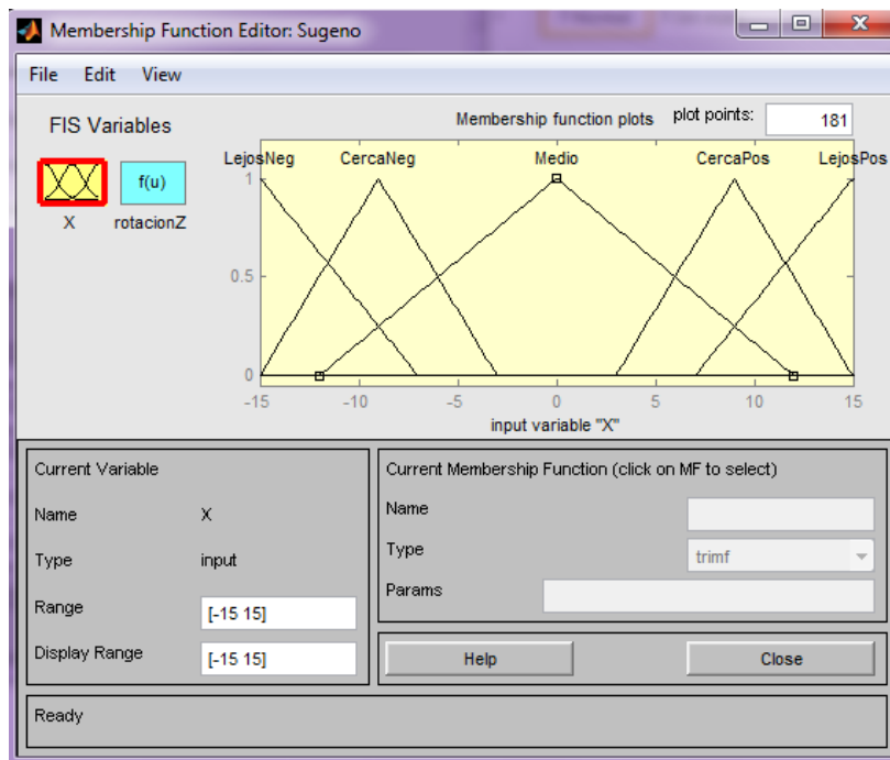
fig. 82. Funciones de pertenencia para la variable lingüística X
