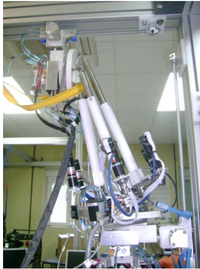
Fig. 25. Fotografía del robot trepa en su fase de desarrollo. Fuente: (Madrid, 2007)
