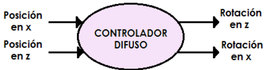
fig. 79. Estructura general del controlador difuso para la plataforma Stewart
