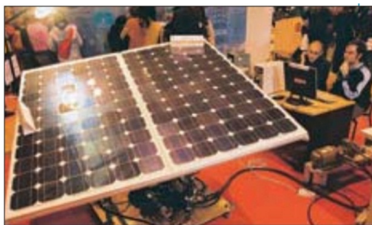
Fig. 26. Fotocelda posicionada por medio de una plataforma Stewart
