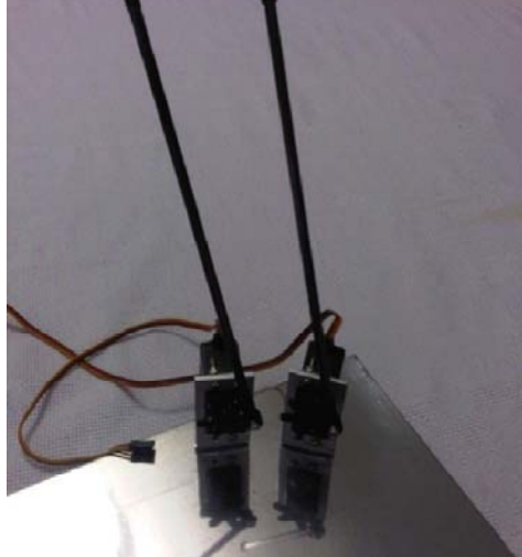
fig. 54. Eslabones acoplados a los servomotores
