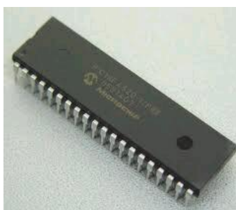
Figura 2.6. Microcontrolador PIC 16F877A [11].
