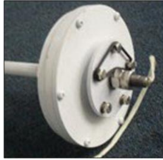
Figura 28. Generador eléctrico 12 V/AC – 15 W
