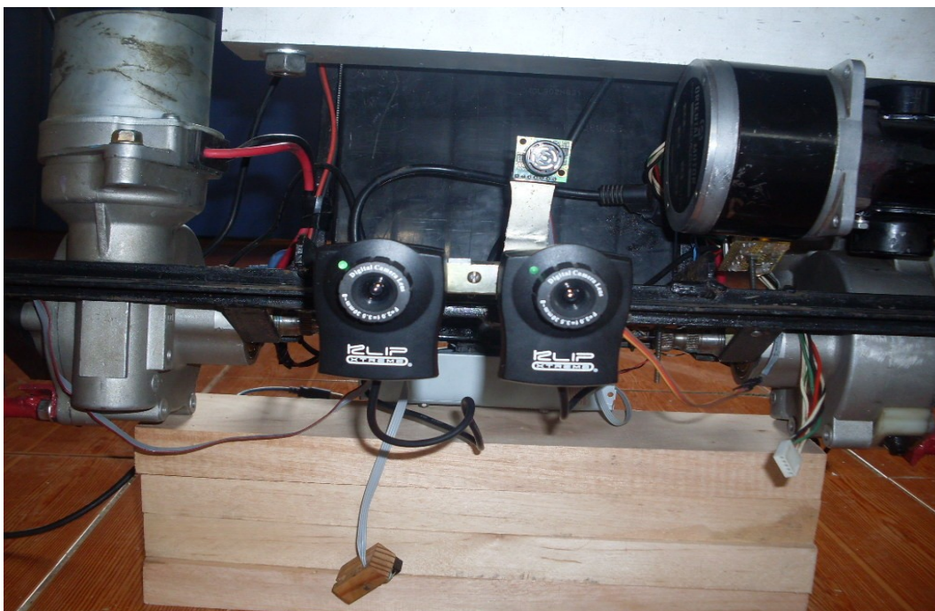
Imagen 4. Las cámaras en disposición binocular.
