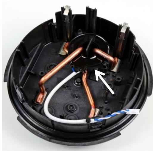
Figura III.4 Interior del medidor Elster
