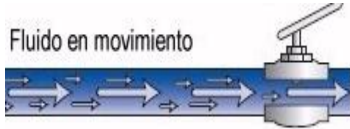
Fig.1-4. Resistencia al flujo y volumen muerto en tubería. 4
