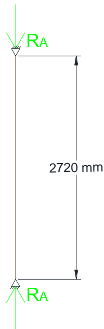
Figura 3.6: Dimensiones de la columna del horno.
