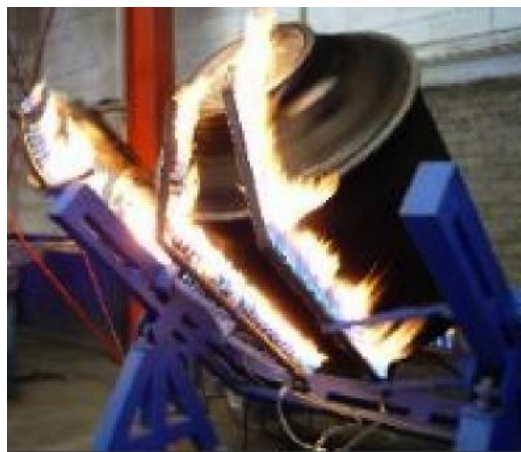
Figura 1.21: Máquinas con Calentamiento mediante flama abierta.
