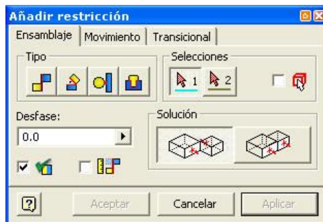
Figura 4.3: Restricciones de Ensamblaje.
