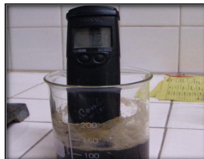
Figura 55. Ácido nítrico y bureta, ácido nítrico con efluente, medición de pH por cada ml de ácido añadido
