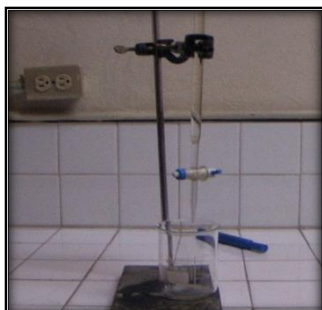
Figura 55. Ácido nítrico y bureta, ácido nítrico con efluente, medición de pH por cada ml de ácido añadido
