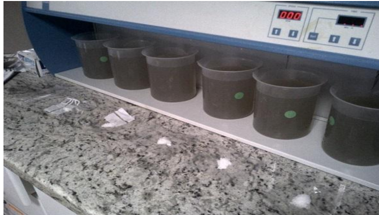
Figura 27. Prueba de jarras-concentraciones de sulfato de aluminio
