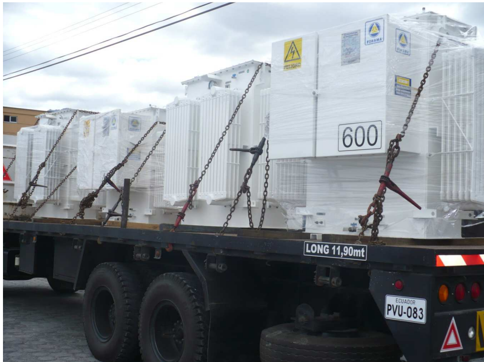
Transporte de transformadores terminados
