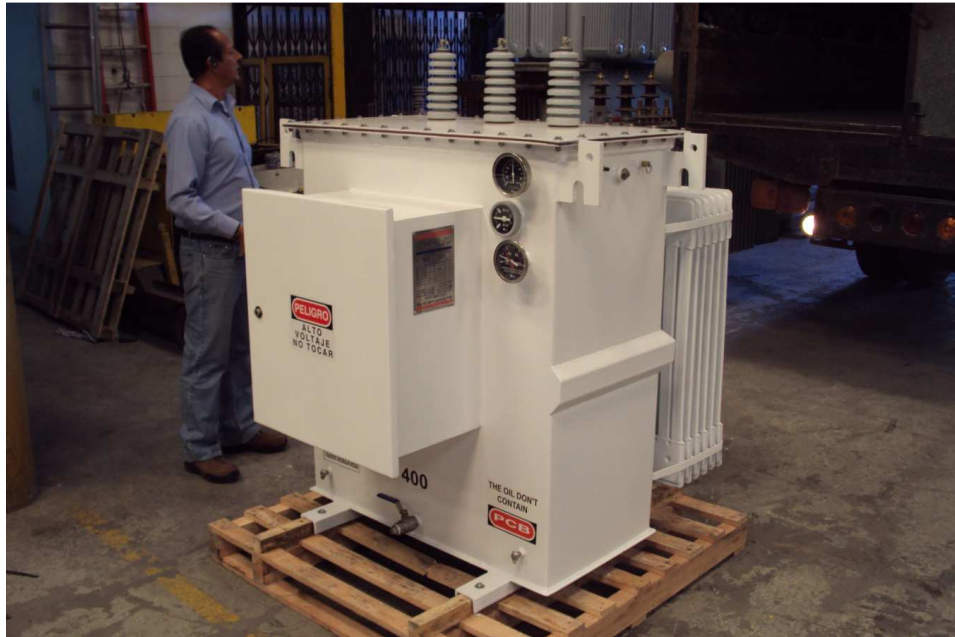
Apreciación de dimensiones de un transformador
