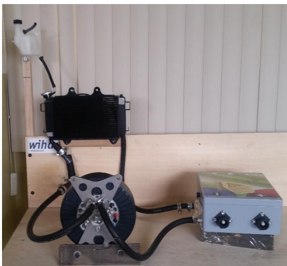
Figura 6.2 Banco de pruebas- sistemas de refrigeración- motor -controlador.
