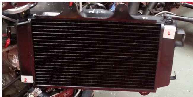
Figura 5.22 Puntos referenciales para la toma de datos. 1. Entrada del líquido refrigerante. 2- salida del líquido refrigerante.
