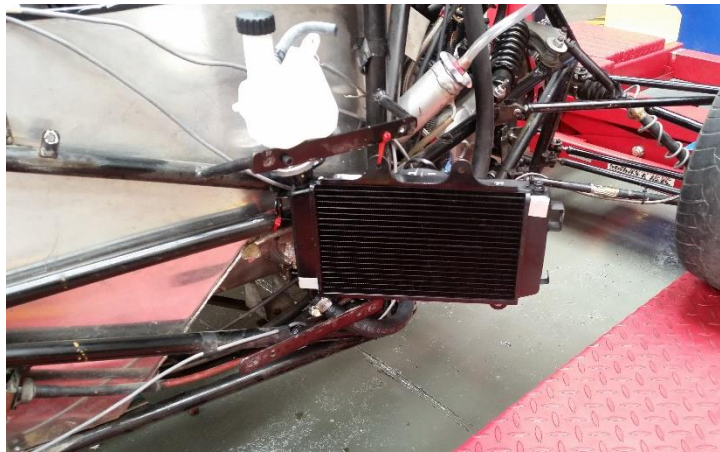
Figura 5.21 Intercambiador de calor FSAE Eléctrico.
