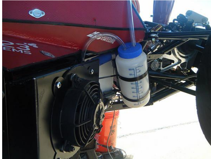
Figura 4.15 Sistema de refrigeración vehículo MY15 [12]
