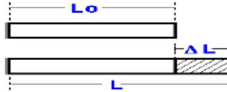
**FIGURA 1.56 Dilatación lineal en un tramo de tubería.**<sup>96</sup>
