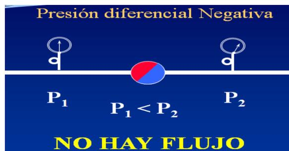
**FIGURA 1.38 Diferencial de presión negativa en una línea de flujo de condensado**<sup>71</sup>
