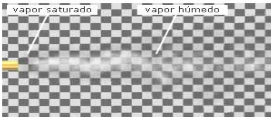
**FIGURA 1.7** El vapor saturado será invisible a la salida de una tubería al ser venteadado la atmosfera<sup>17</sup>.
