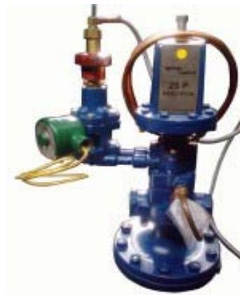
***FIGURA 3.13*** *Válvula reguladora de presión y temperatura.*<sup>156</sup>
