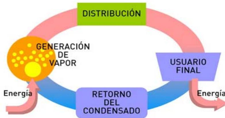
*FIGURA 1.1 Esquema del Ciclo ideal de vapor en circuito cerrado<sup>2</sup>*
