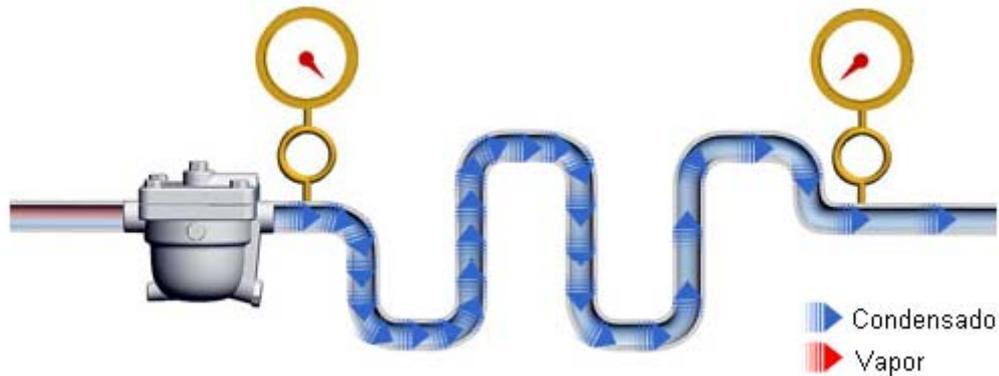
**FIGURA 1.49** Tubería de condensado con cambio de trayectos, forma la contrapresión.<sup>86</sup>
