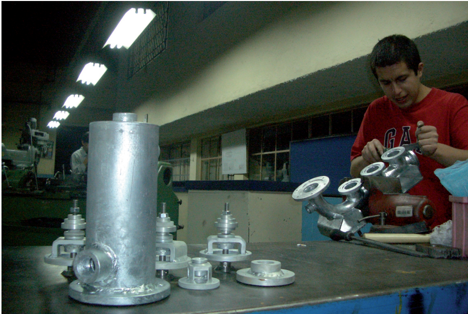
Figura 10. Proceso de construcción de prototipo de Ariete Hidráulico
