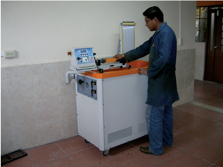
Figura 11. Banco para Pruebas de Golpe de Ariete- Tanque Hidrodinámico
