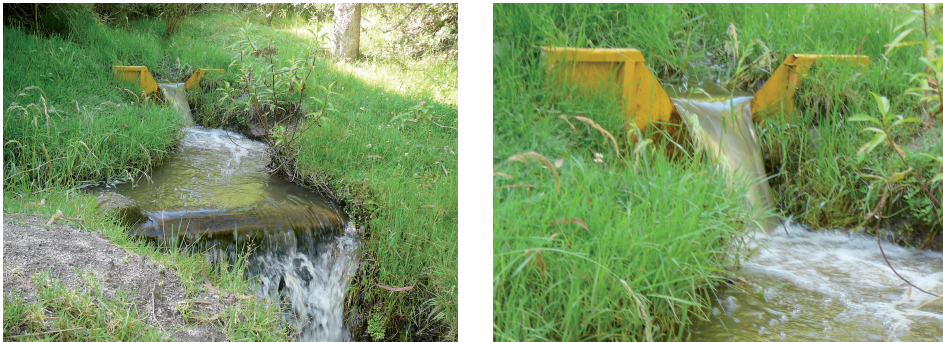
Figura 2. Medición del caudal de quebrada Yumacay- Vertedero Triangular de 90^\circ
