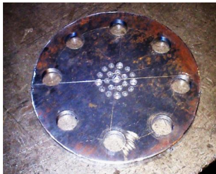
Figura 3.6. Construcción válvula de entrega.
