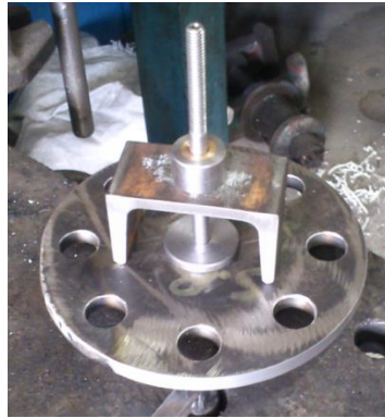
Figura 3.5. Construcción válvula de impulso.
