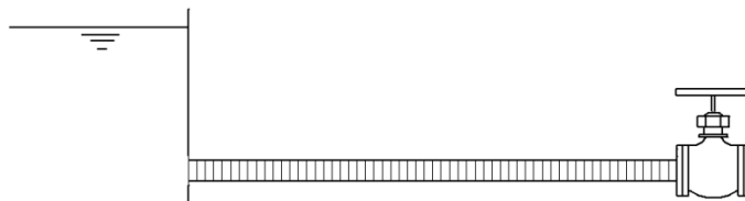
Figura 1.10. Depresión en toda la tubería.
