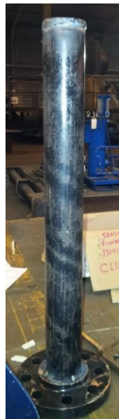
Figura 3.4. Construcción cuerpo de la cámara de aire.
