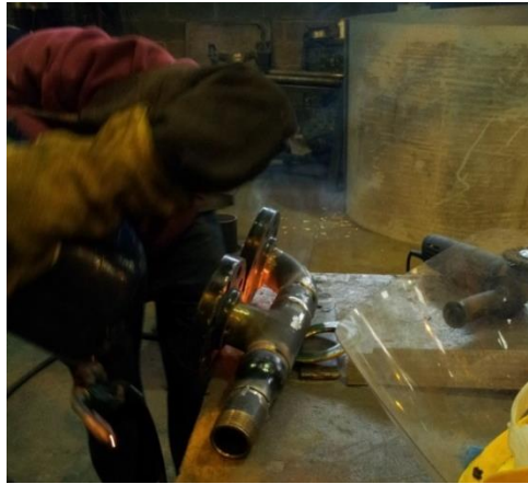
Figura 3.3. Construcción cuerpo de la bomba.
