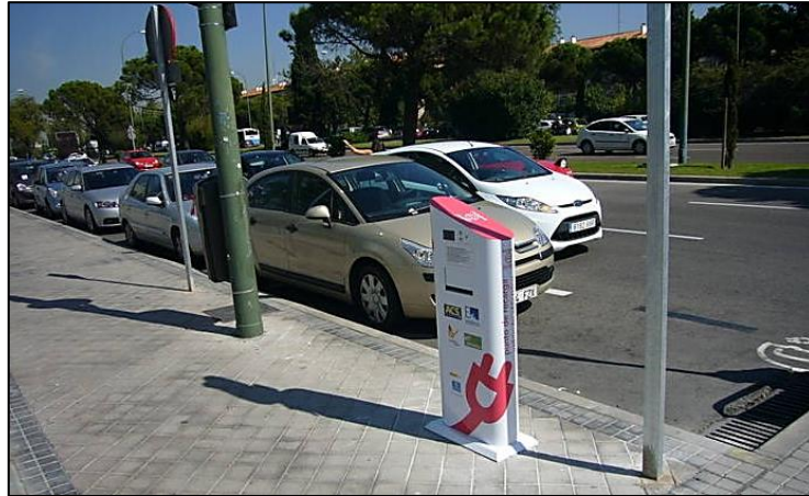
Figura 2.10, Puntos de recargas de vehículos eléctricos en la vía pública Fuente: CIRCUTOR, “Recarga inteligente de vehículos eléctricos,”
