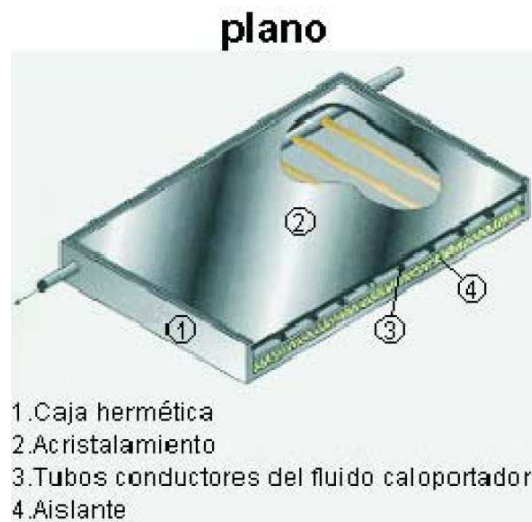
Figura 1.18 “Esquema de captador plano”
