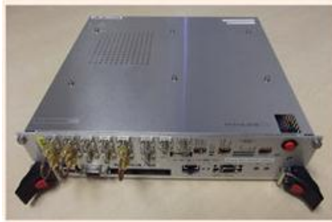
Figura 4.5 Prototipo basado en IEEE 802.22 externamente.
