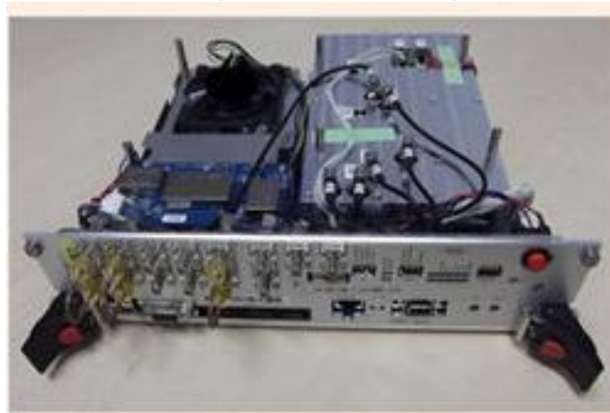
Figura 4.6 Prototipo basado en IEEE 802.22 internamente.
