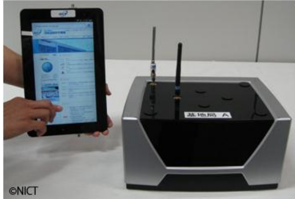
Figura 4.4 Prototipo de Tablet y Estación Base WLAN con TVWS.
