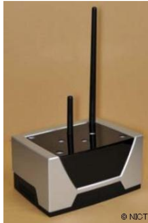
Figura 4.2 Estación Base para Espacios en Blanco (WSBS).
