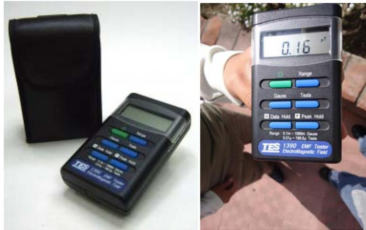
**Figura 3.3** Equipo de medición TES-1390.
