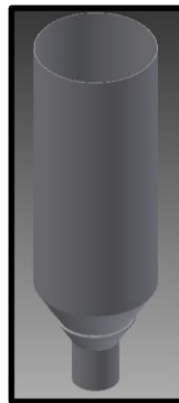
Figura 34. Tolva de la prensa expeller con capacidad de 3kg.
