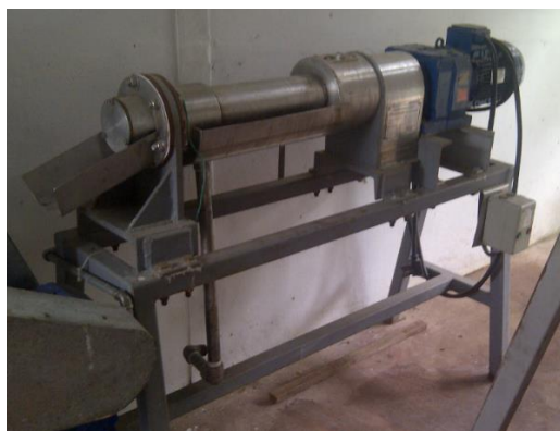
Figura 13. Molino de extracción de aceite de chonta antes de su rediseño.
