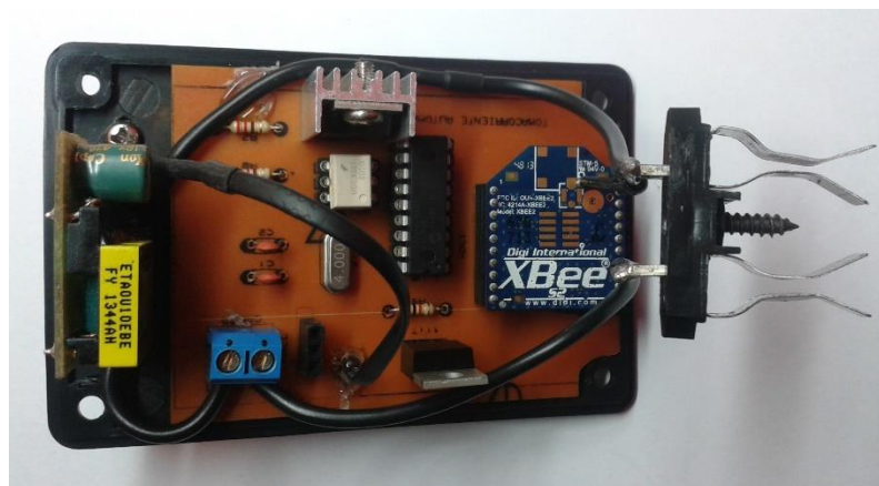
Figura 2.19: Vista 3D tarjeta tomacorriente automático
