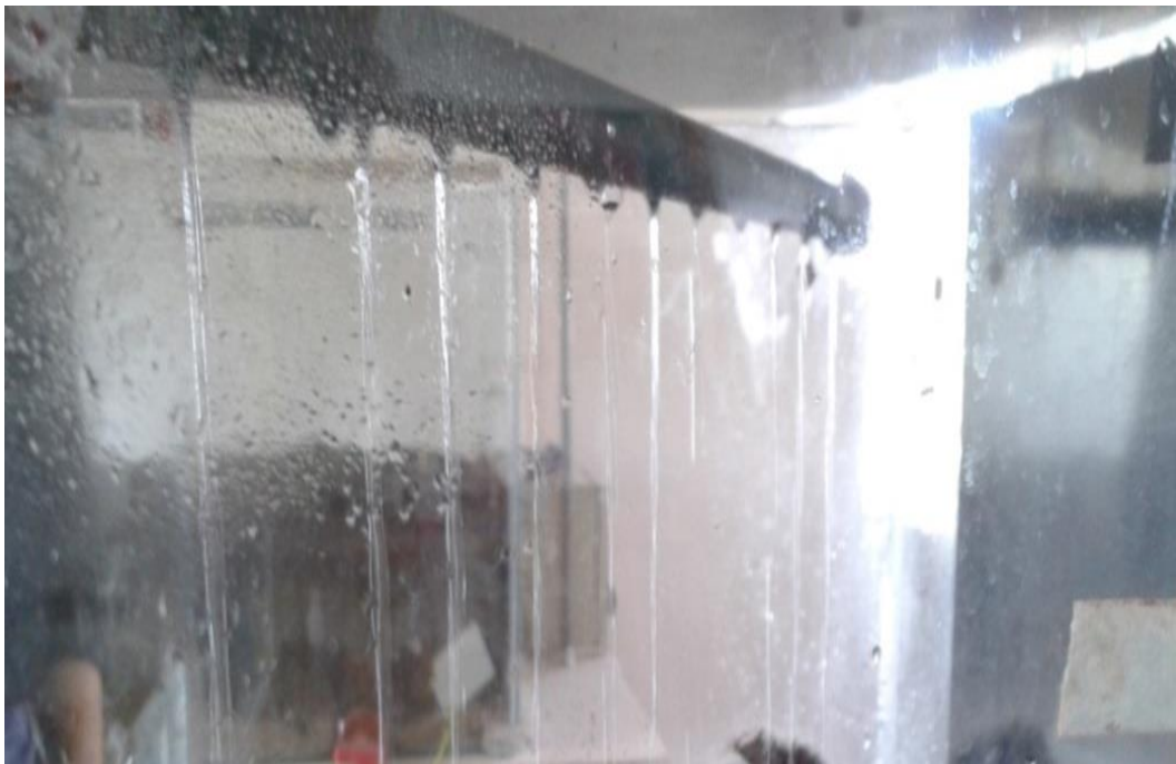
Figura 35. Tubería instalada para simular lluvia dentro del biorreactor Imagen: Daniela Cadena
