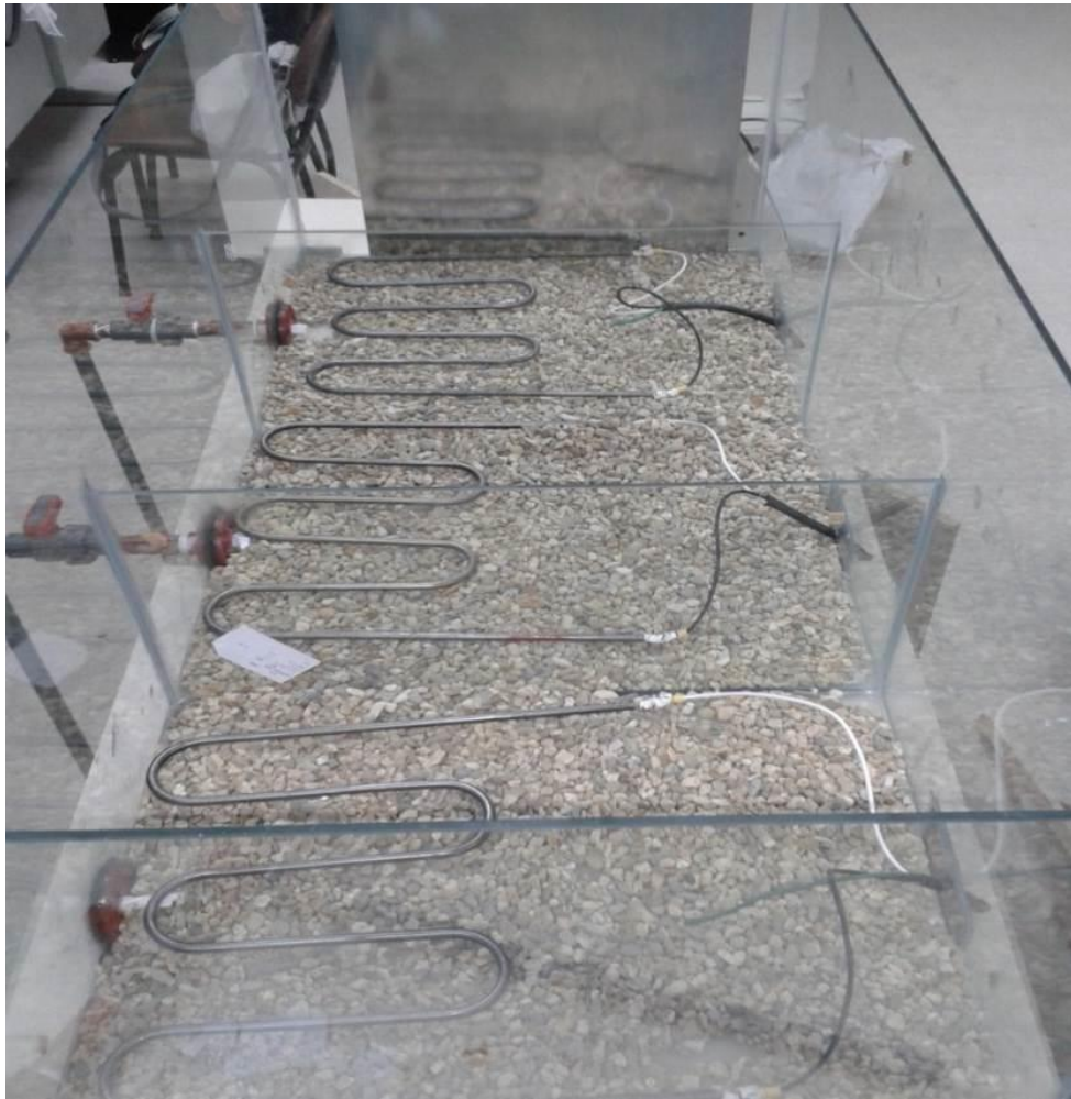
Figura 40. Lecho de grava para las resistencias Imagen: Daniela Cadena
