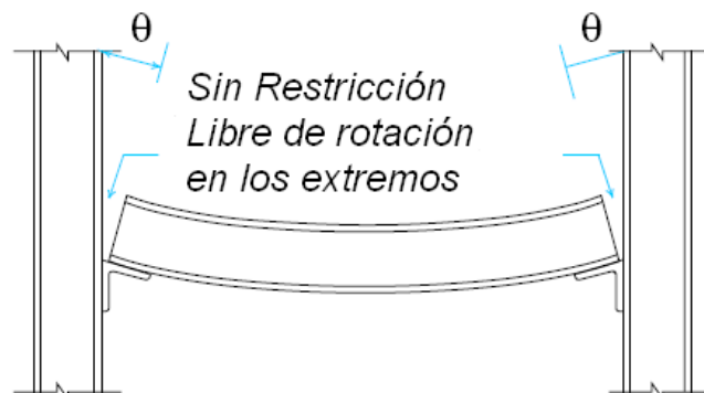
Fig. No. 1.7 Conexión simple o de corte
