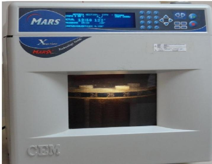
**Fotografía 21.** Sistema de Digestión por Microonda
