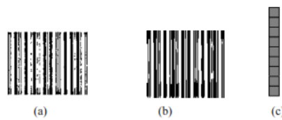
Figura 33. a) Operación dilatante con (c) se obtiene (b) (Velez Serrano, Moreno, Sanchez , & Sanchez , 2003).
