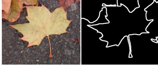
Figura 42. Segmentación basada en color aplicando el algoritmo división y unión de regiones ( split and merge ) (Velez Serrano, Moreno, Sanchez , & Sanchez , 2003).
