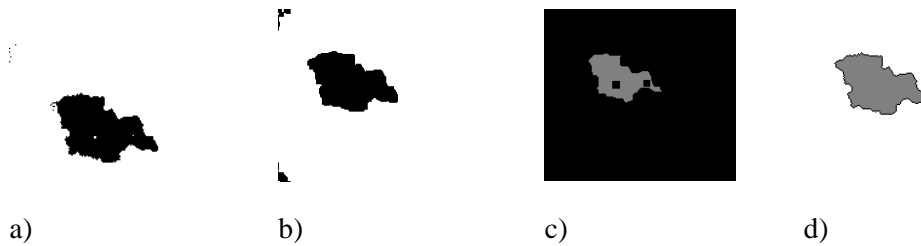
Figura 66. Procesamiento de la imagen a) Umbralizacion, b) erosión, c) dilatación, d) región de interés
