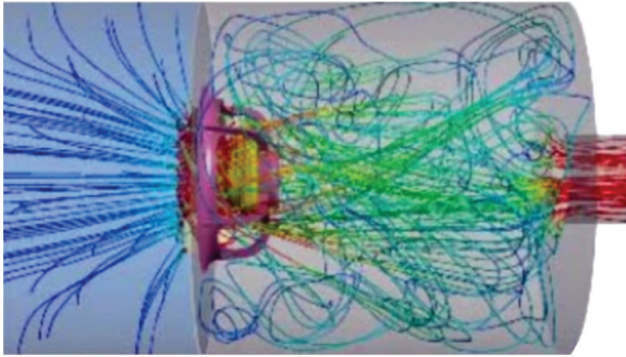
Figura 9. Simulación mediante computadora de un ventilador en un refrigerador no frost
