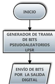
Figura 32 Diagrama de flujo del modulador
