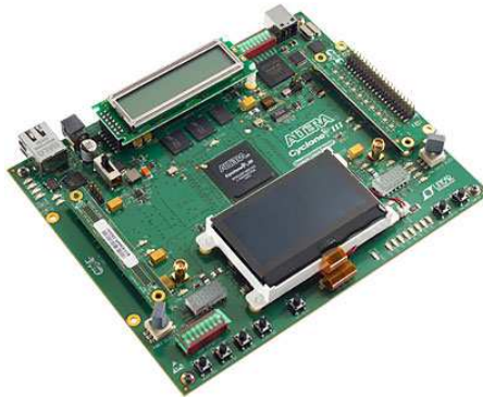
Figura 17 Tarjeta de desarrollo FPGA Cyclone III de Altera (EP3C120F780C7)
