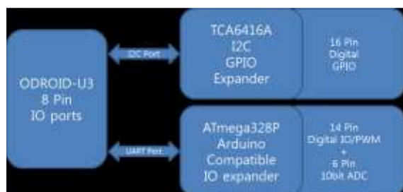
Figura 4.65 Diagrama de Bloque comunicación Odroid & GPIO
