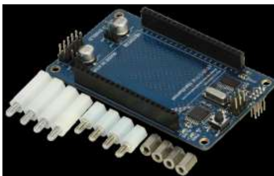
Figura 4.63 Vista de la GPIO
