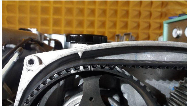
Figura 39. Diente adelantado en la polea del árbol de levas en admisión. Fuente: Autores
