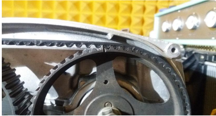
Figura 36. Diente retrasado en la polea del árbol de levas en escape. Fuente: Autores
