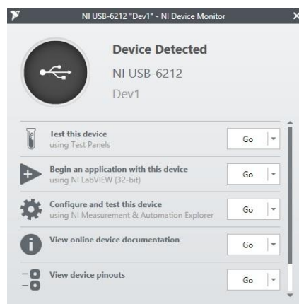
Figura 60. Ventana de reconocimiento de la tarjeta DAQ 6212 con el ordenador. Fuente: Autores
