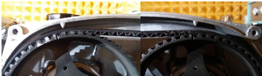
Figura 41. Dientes retrasados para los árboles de levas en admisión y escape. Fuente: Autores
