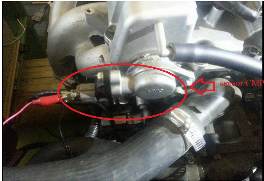
Figura 57. Ubicación del sensor CMP en el motor. Fuente: Autores
