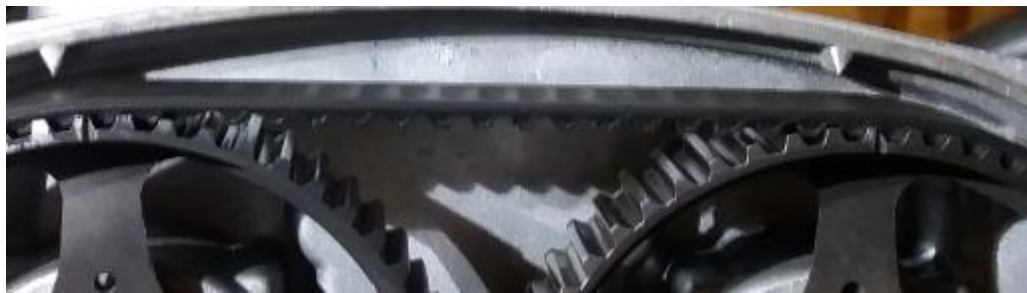
Figura 40. Dientes adelantados para los árboles de levas en admisión y escape. Fuente: Autores
