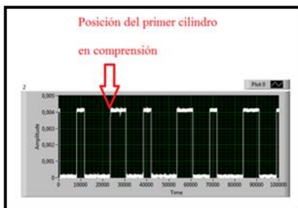
Figura 71. Señal del sensor CMP en función del PMS del primer cilindro. Fuente: Autores
