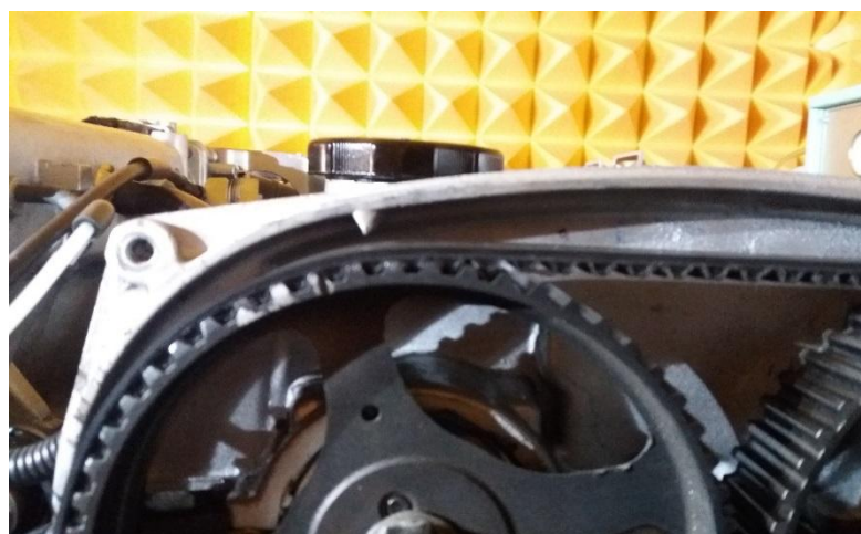
Figura 38. Diente retrasado en la polea del árbol de levas en admisión. Fuente: Autores
