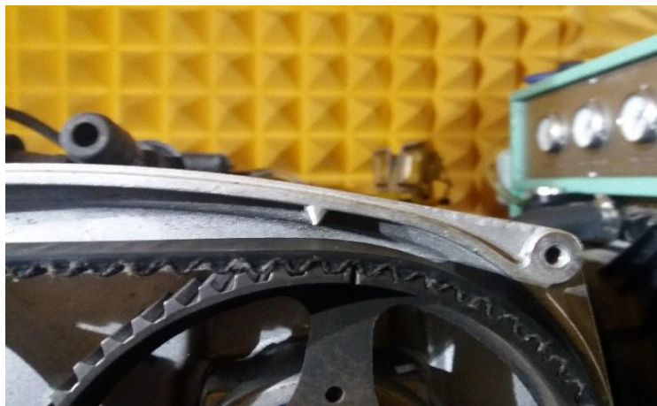
Figura 37. Diente adelantado en la polea del árbol de levas en escape. Fuente: Autores
