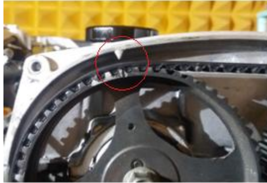
Figura 33. Señales de calado de la polea del árbol de levas en admisión. Fuente: Autores
