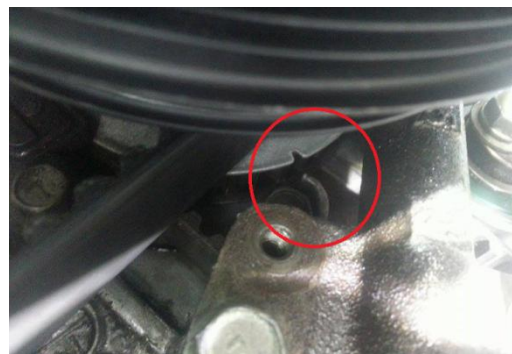
Figura 35. Señales de calado de la polea del cigüeñal. Fuente: Autores.
