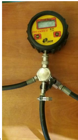
Figura 29. Conexiones del regulador de presión de combustible. Fuente: Autores
