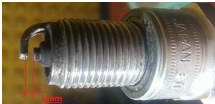
Figura 25. Bujía calibrada a 1 mm. Fuente: Autores
