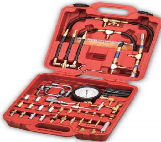
Figura 27. Kit para medir la presión de gasolina, GT-1021. Fuente; (GT SUPER TOOLS, 2010)
