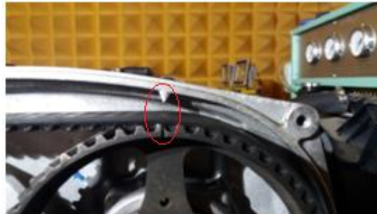
Figura 34. Señales de calado de la polea del árbol de levas en escape. Fuente: Autores
