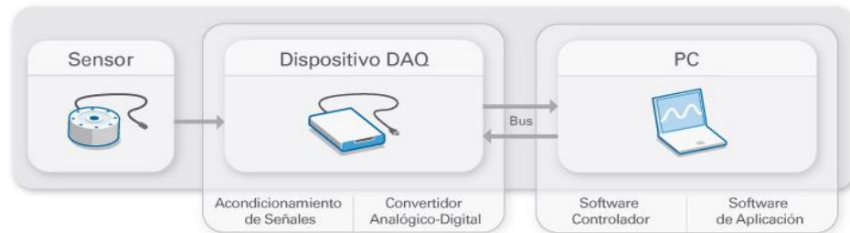
Figura 18. Proceso para la adquisición de datos. Fuente; (INSTRUMENTS, 2014).
