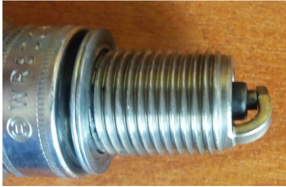
Figura 24. Bujía calibrada a 0 mm. Fuente: Autores
