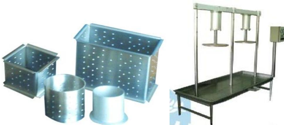
Figura 32. Moldes y prensa hidráulica. Fuente: Proingal por A. Bastidas y G. Cando, 2014
